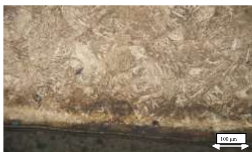
Pav. 3.4 Azotintų druskose, eksploatuotų įdėklų mikrostruktūros.
