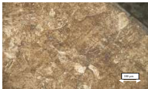
Pav. 3.1 Termiškai gerintų, neeksploatuotų įdėklų mikrostruktūra.
