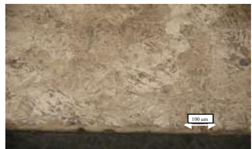
Pav. 3.2 Termiškai gerintų, eksploatuotų įdėklų mikrostruktūra.
