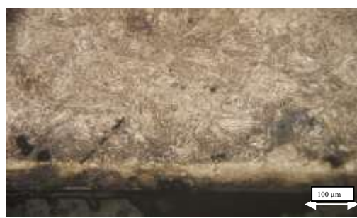
Pav. 3.4 Azotintų druskose, eksploatuotų įdėklų mikrostruktūros.
