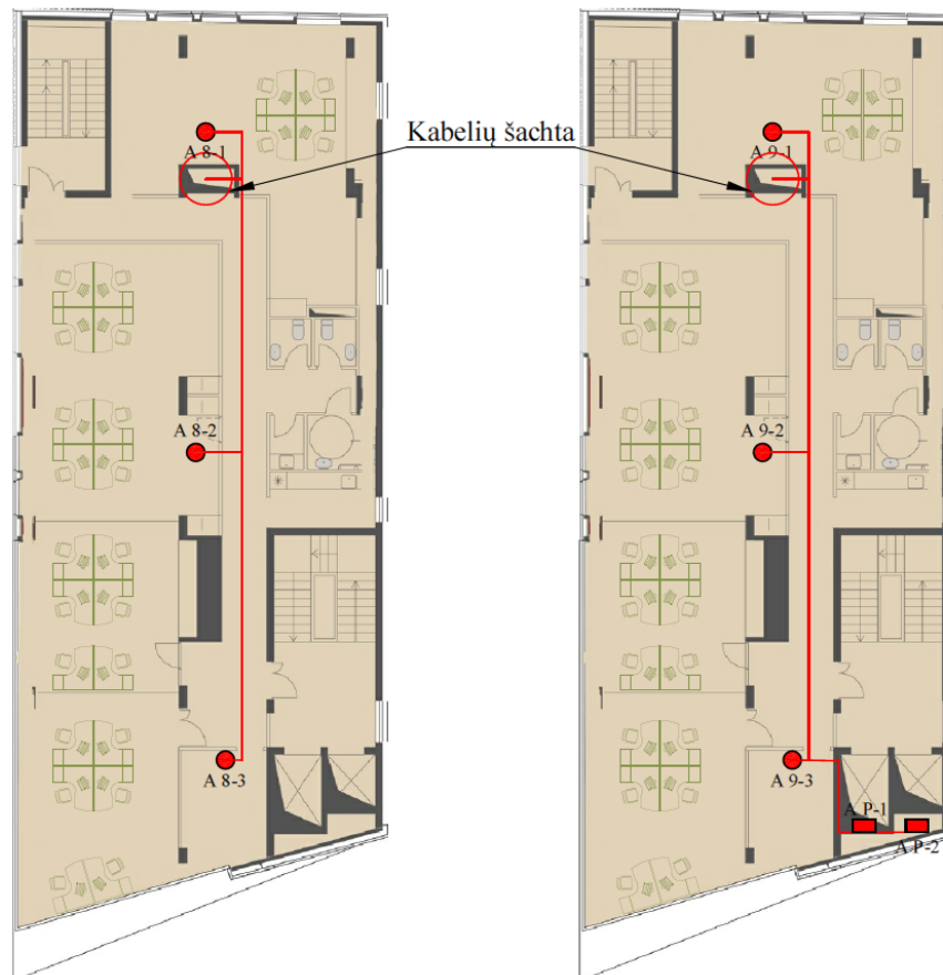
14 pav. Kabelio praklojimas, antenų išdėstymas (8 - 9-as aukštai)
