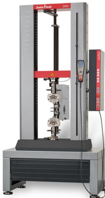
2.12 pav. „Zwick/Roell ProLine serijos“ bandymų mašina [12p].
