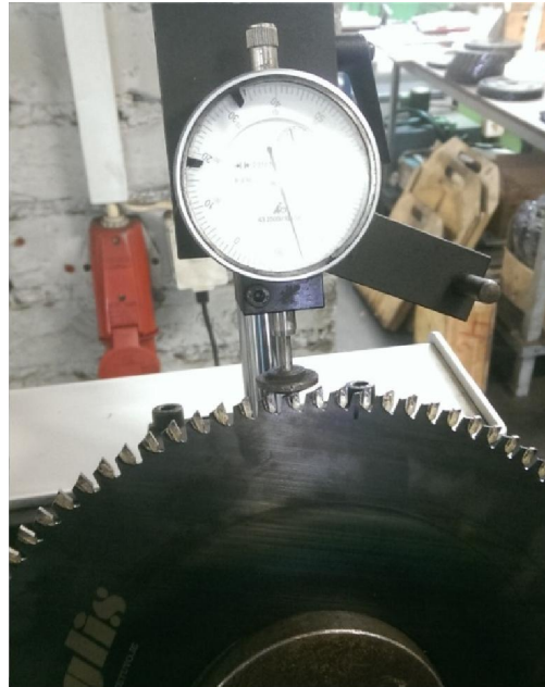
3.9 pav. Plokštelių aukščio matavimas [8p].
