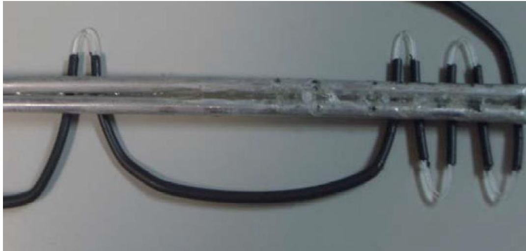
2.1 pav. POF šviesolaidžio panaudojimas vandens lygiui nustatyti [3]
