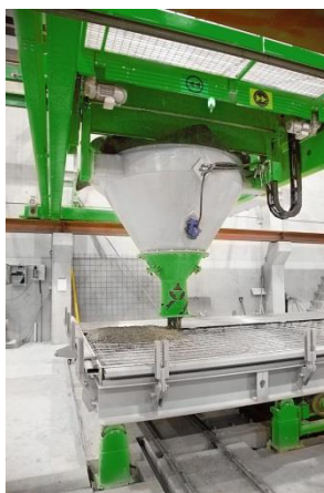
15 pav. Betono mišinio tiektuvas
