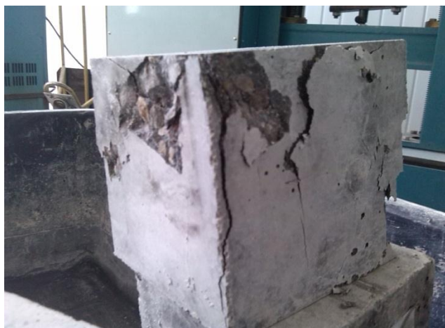
7.4 pav. Betono bandinys po gniuždymo bandymo
