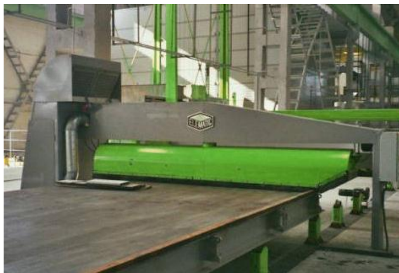
4.6 pav. Padėklų tepimo mašina ELEMATIC „E9-4.0o“ [16]
