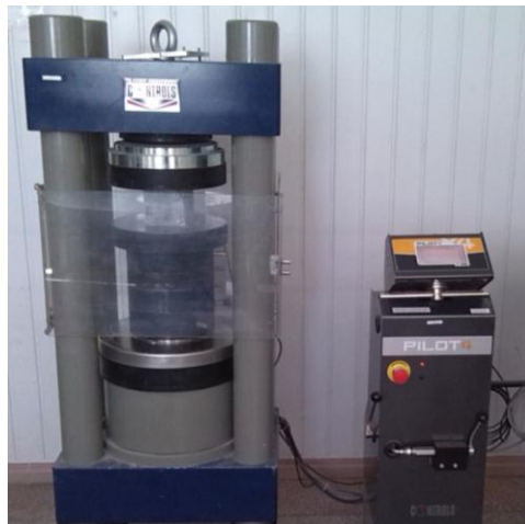
7.3 pav. Gniuždymo presas Controls “PILOT4”
