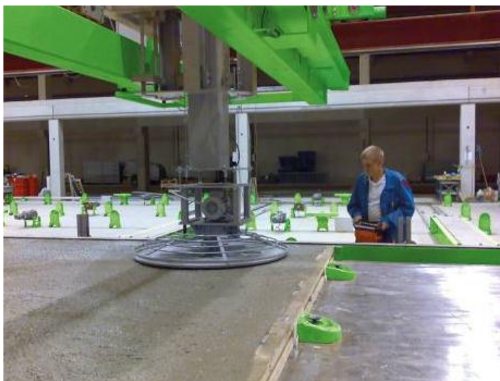
4.14 pav. Betono šlifavimo įrenginys ELEMATIC „E9-900“ [26]
