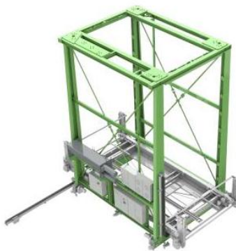
4.15 pav. Plokščių kėlimo įrenginys ELEMATIC „E9-30I“ [28]
