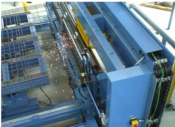
4.9 pav. Armatūros tinklo virinimo įrenginys WZ-2500A
