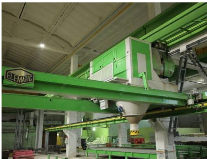
4.12pav. Betono mišinio klotuvas ELEMATIC „Comcaster EB2350“ [23]
