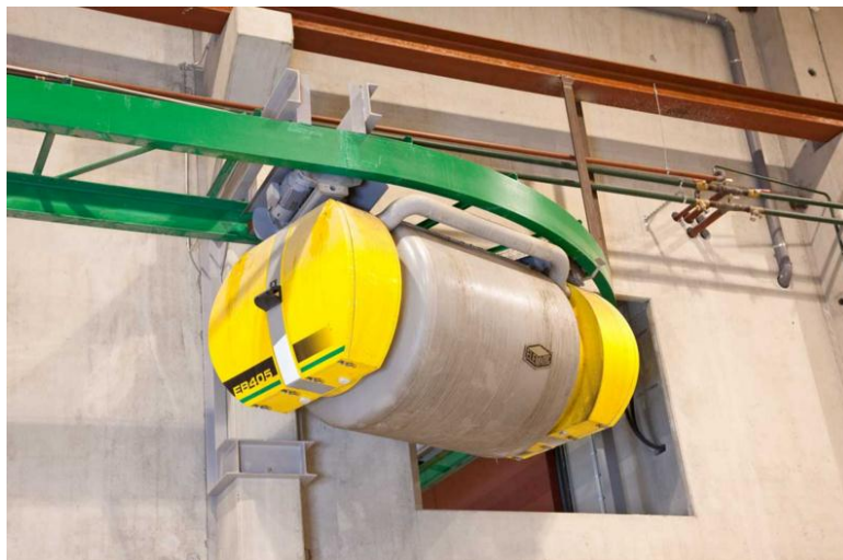
4.11 pav. Betono mišinio transportavimo vežimėlis ELEMATIC „EB405“ [22].
