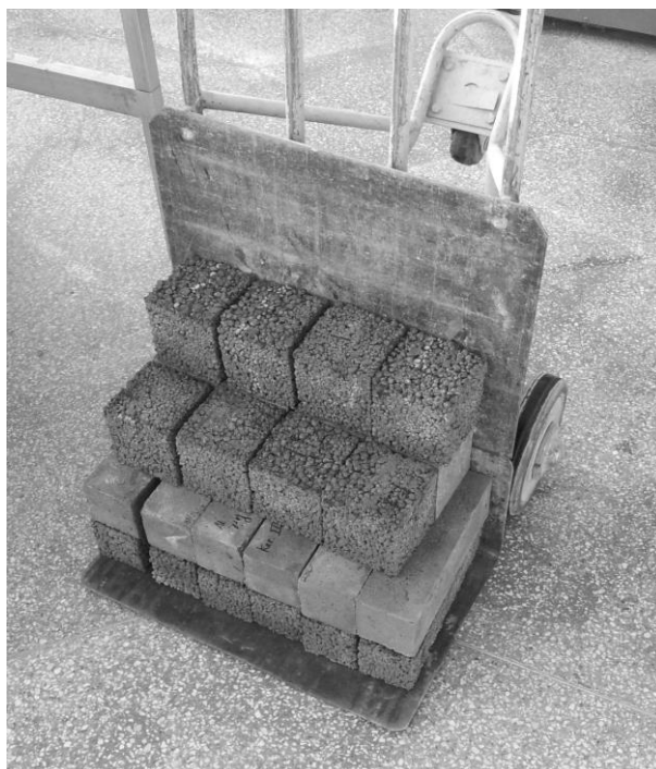
9 pav. Tyrimui pagaminti keramzitbartonio ir stikloporo blokelių
