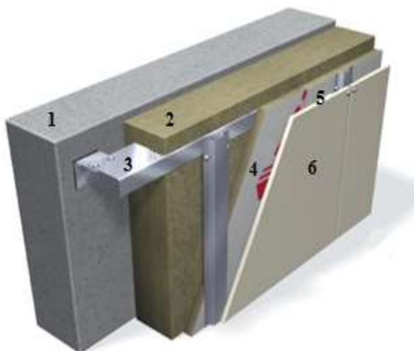
2.3.1 pav. Išorinė vėdinama šiltinimo sistema:
