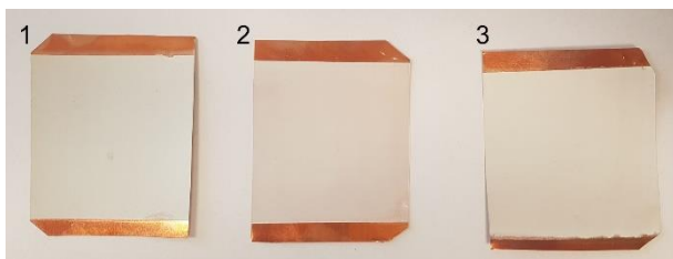
2.3 pav. Vario folijos dangos pavyzdžiai: 1 – PZT/PMMA, 2 – PZT/PS, 3 – PZT/PVB
