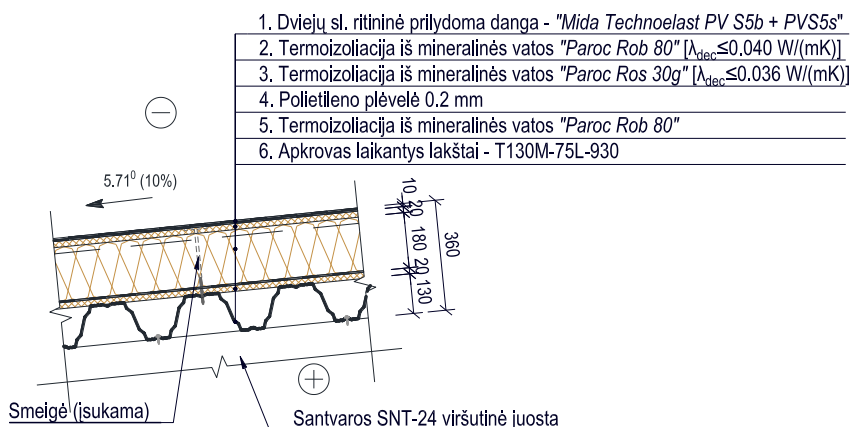
2.2 pav. Sutapdinto stogo konstrukcija.
