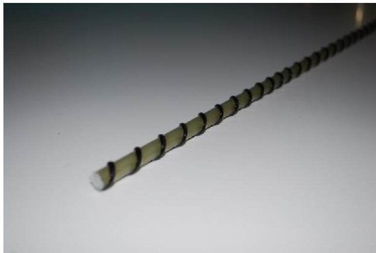
2.1 pav. Stiklo pluoštu armuotų polimerinių armatūros FRPR-GV-A1 strypas
