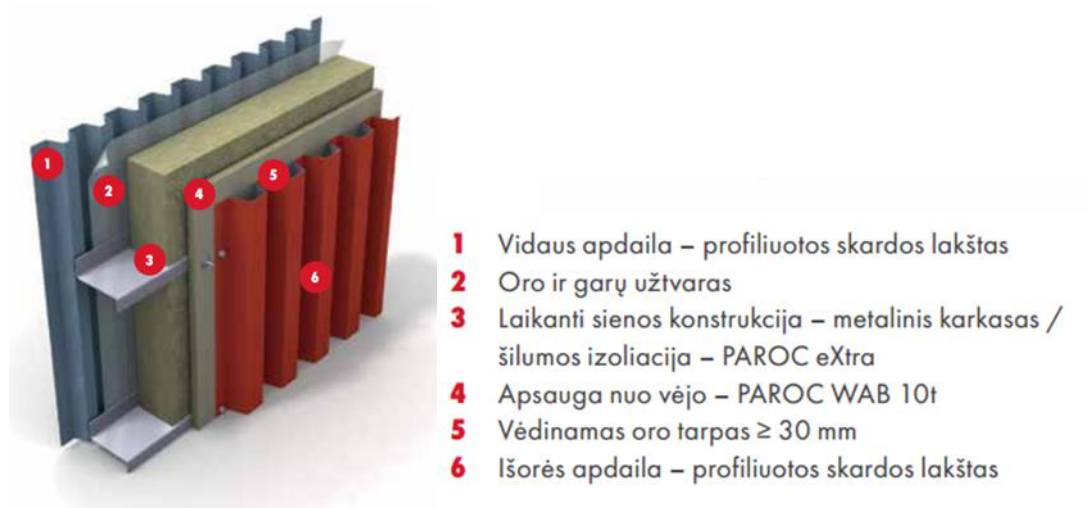
2.9 pav. Tiriamasis sienos šiltinimo mazgas
