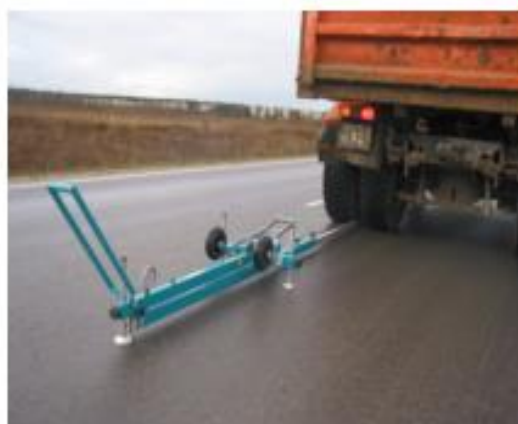
4.4.4 pav. Dinaminio štampos bandymas. Benkelmeno sijos bandymas.
