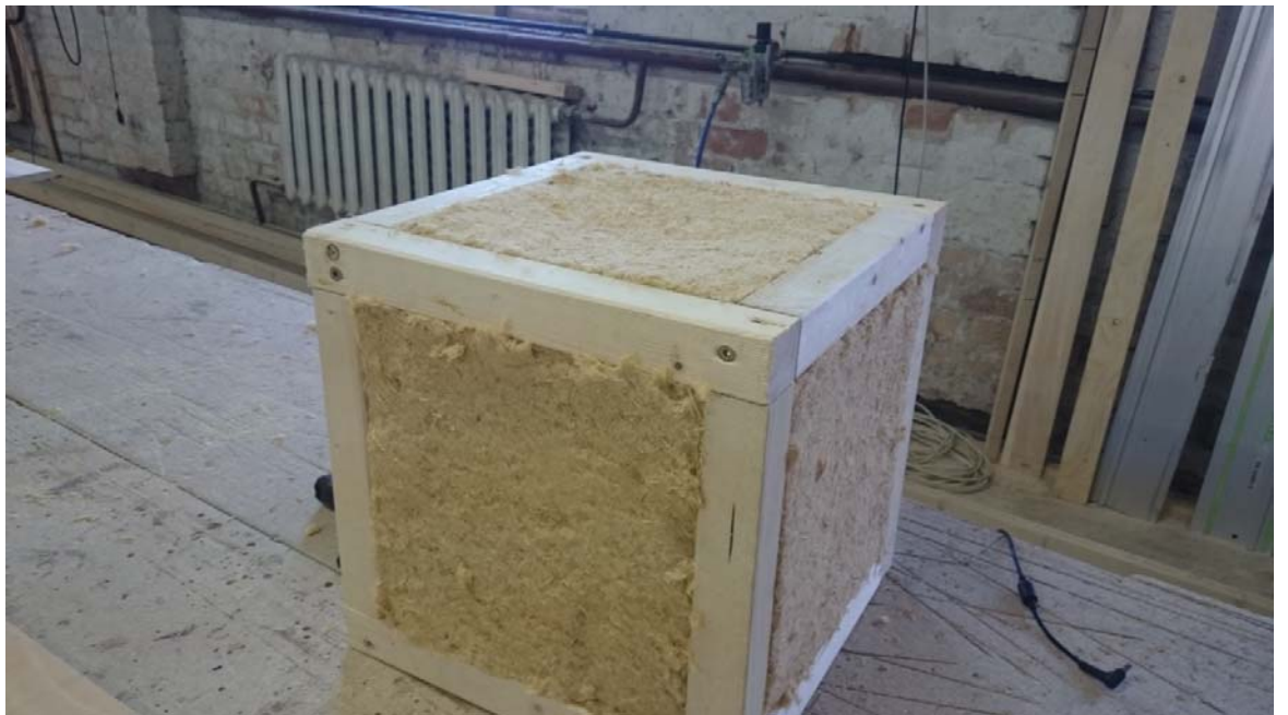
3.14 pav. Rėmas su sudėta medžio plaušo vata.
