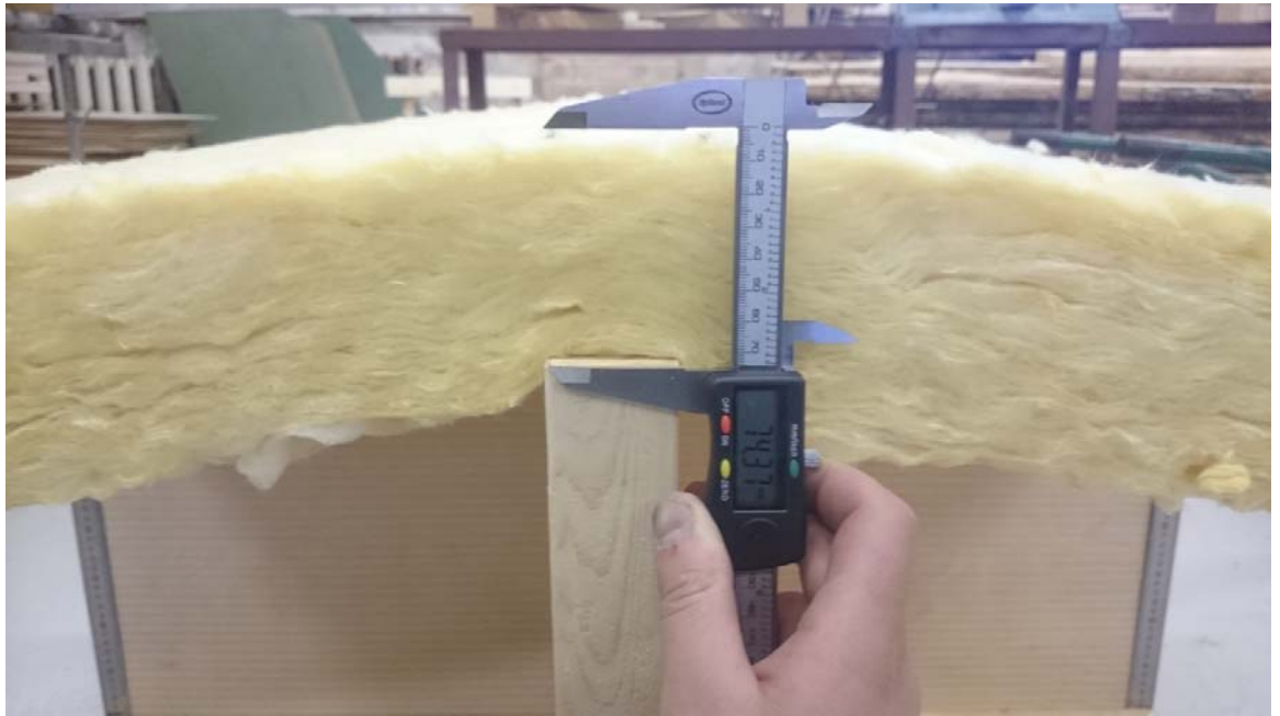
3.24 pav. Su slankmačiu matuojamas stiklo vatos susigniuždymas.
