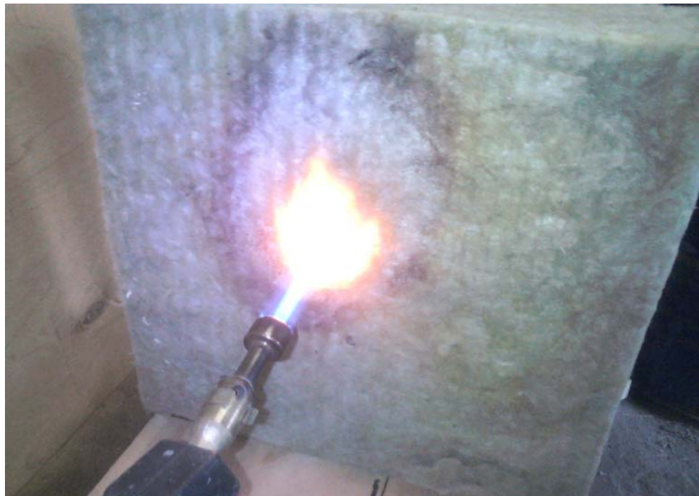
3.5 pav. Deginama akmens vata „ROCKWOOL“.
