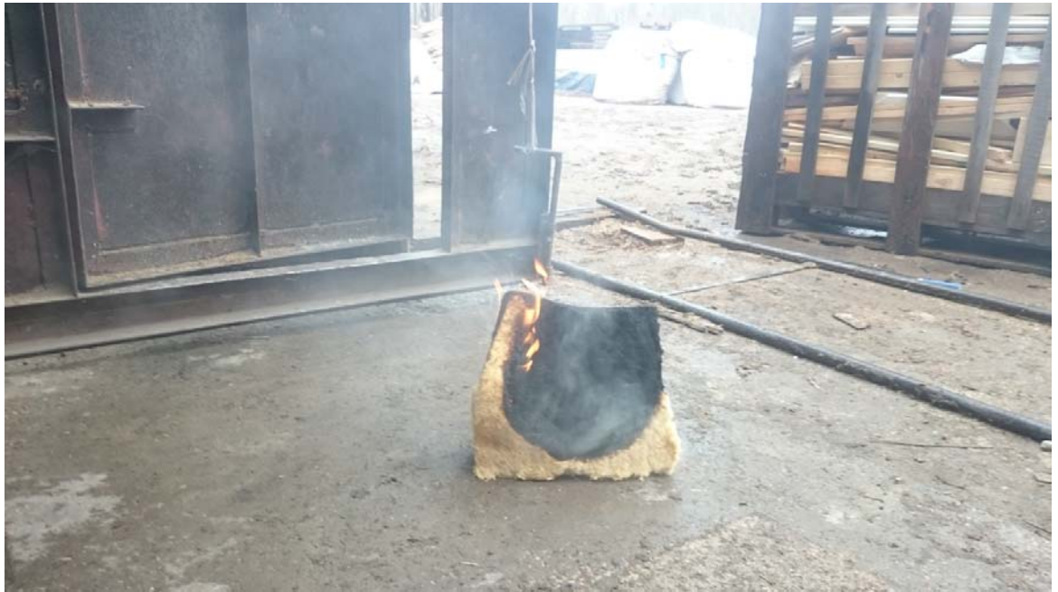
3.10pav. Nesustojanti degti medžio plaušo vata.
