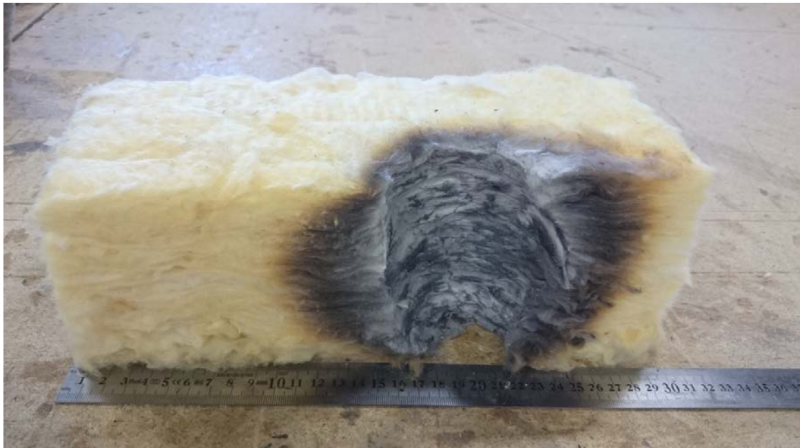
3.7 pav. Stiklo vatos skerspjūvis.
