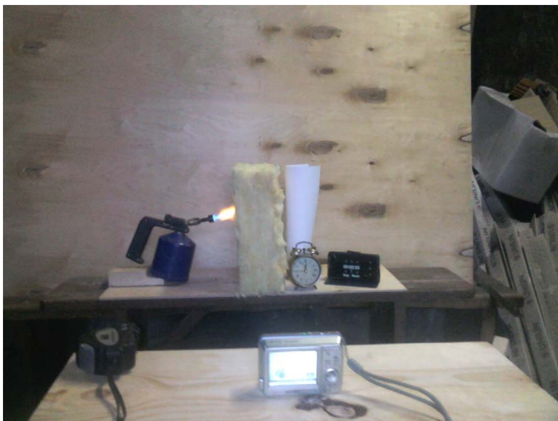
3.2 pav. Ugniai atsparumo bandymo eiga.
