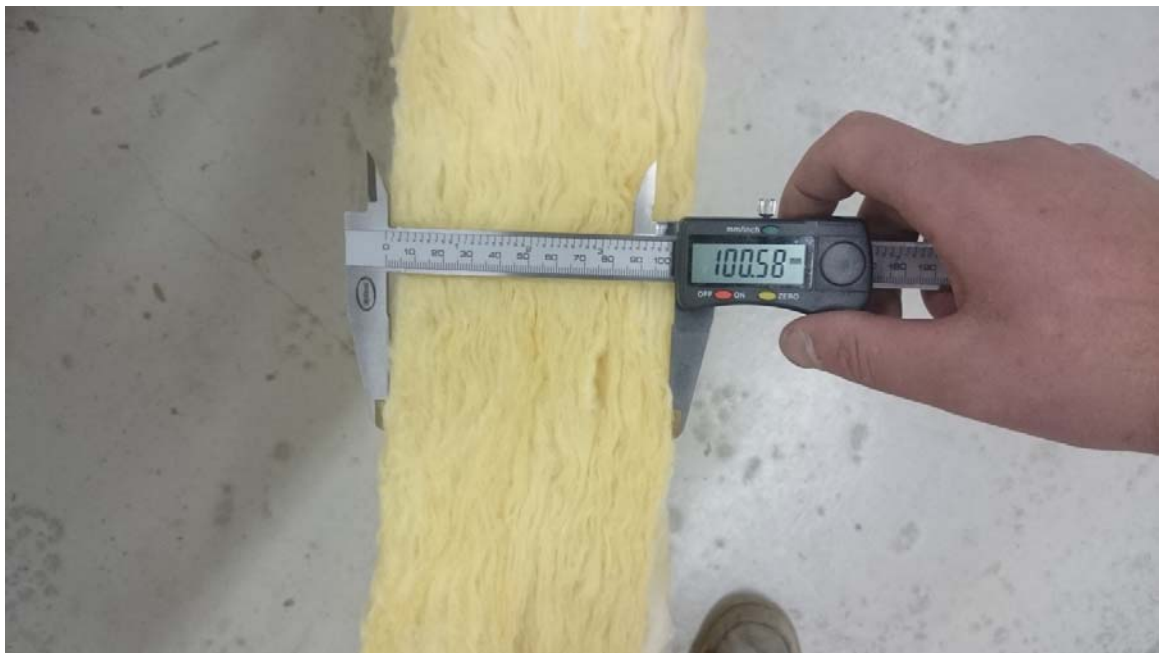
3.25 pav. Su slankmačiu matuojamas stiklo vatos tikrasis svoris.
