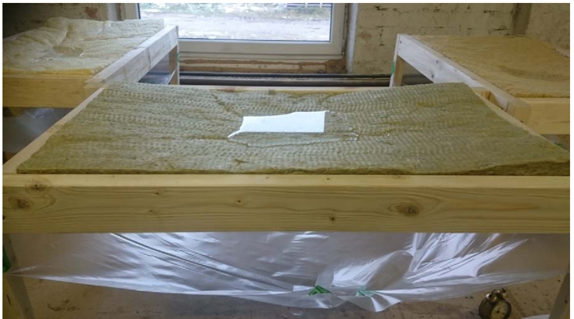
3.19 pav. Vandens įmirkio bandymo pradžia.
