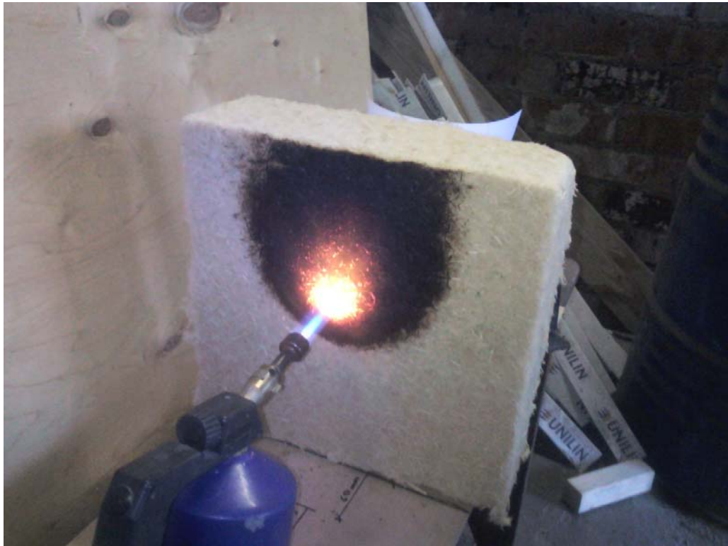
3.6 pav. Deginama medžio plaušo vata „STEICO“.
