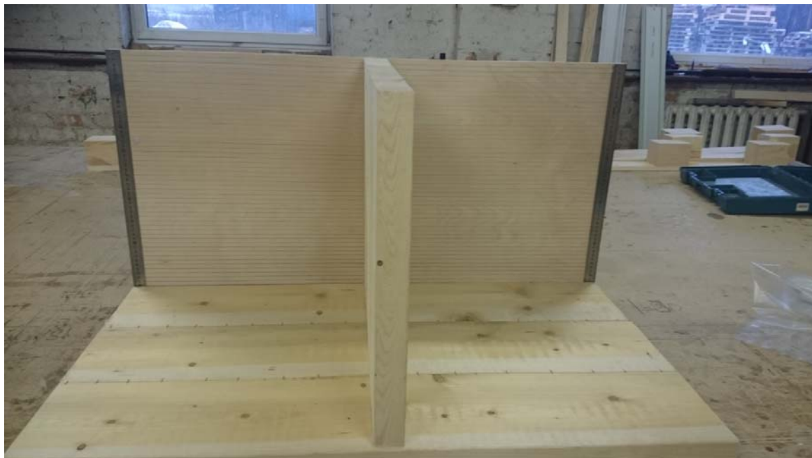
3.21 pav. Stendas vatos plokštės nulinkimui fiksuoti.
