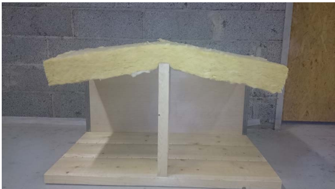
3.22 pav. Vatos nulinkimo fiksavimas.
