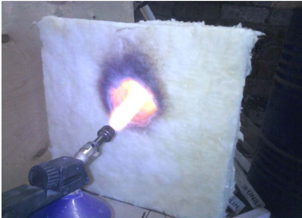
3.4 pav. Deginama stiklo vata „ISOVER“.
