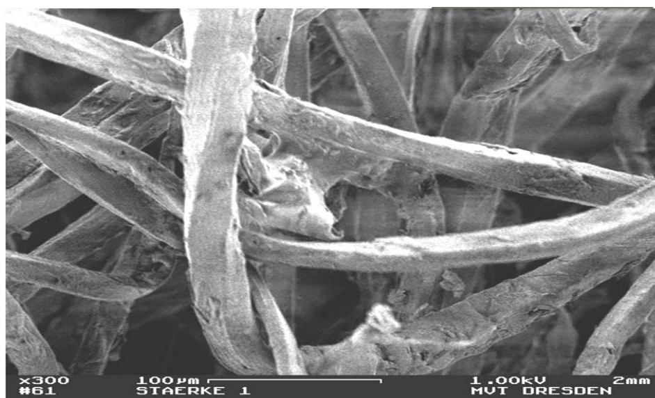
1.6 pav. Medžio plaušo vatos struktūra.
