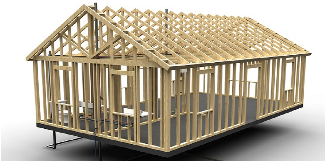
1.1 pav. Karkasinio namo pagrindinis karkasas.
