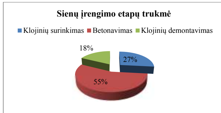
5.1 pav. Sienų įrengimo slenkančiais klojiniais etapų trukmė.
