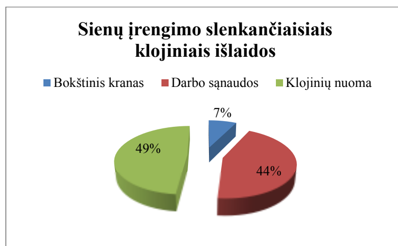
5.5 pav. Sąnaudos dirbant slenkančiais klojiniais.
