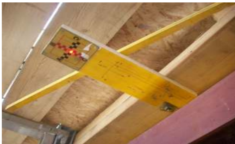
3.5 pav. Vertikalumo matavimo sistemos taikiny, [16].
