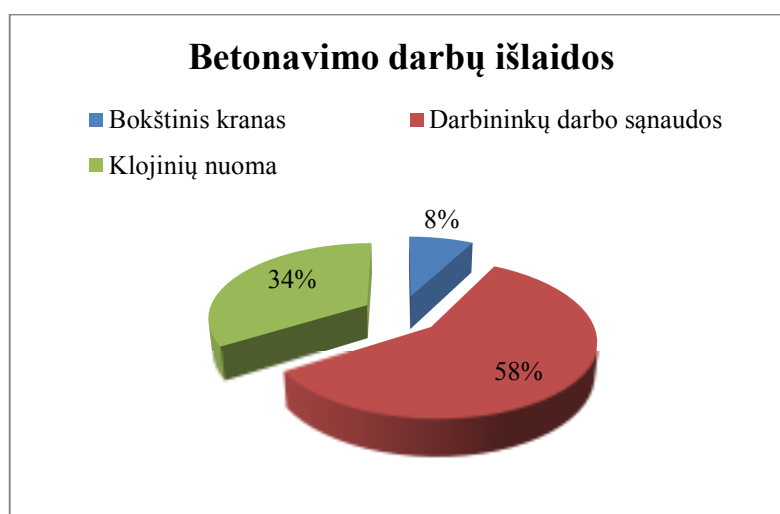
5.3 pav. Sienų betonavimo išlaidos.
