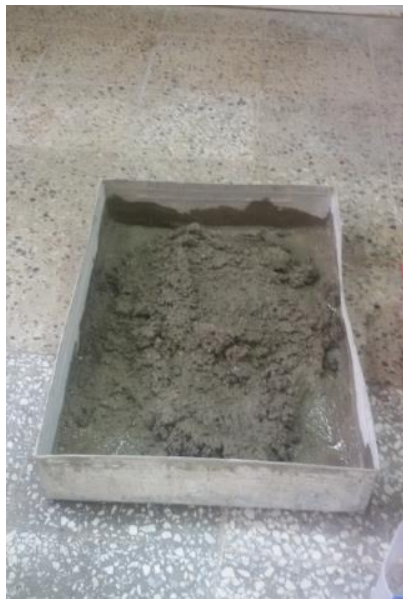
2.4 pav. Betono mišinys Weber S100 sumaišytas su vandeniu
