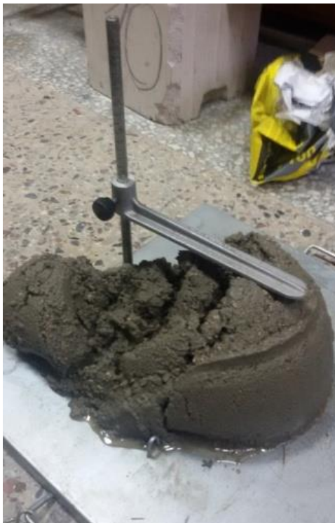
3.19 pav. Betono mišinio be priedų slankumo bandymas
