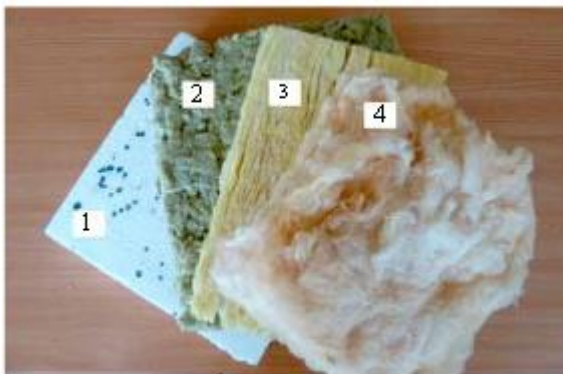
1 pav. Dalis nagrinėtų termoizoliacinių medžiagų: 1 – polistireninis putplastis; 2 – akmens vata; 3 – mineralinė vata; 4 – stiklo vata
