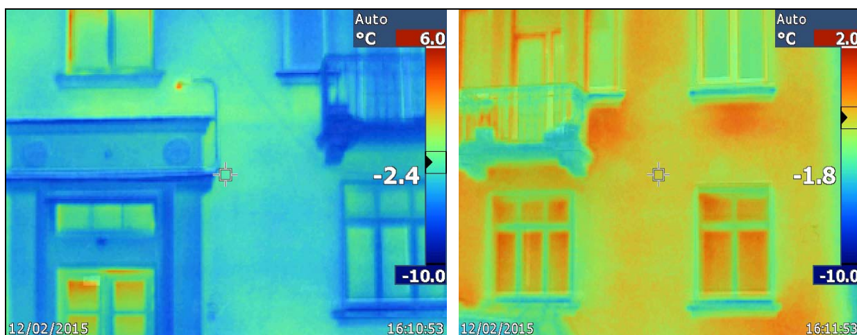
3.8 lentelė. Sienos ir langų termovizinės nuotraukos
