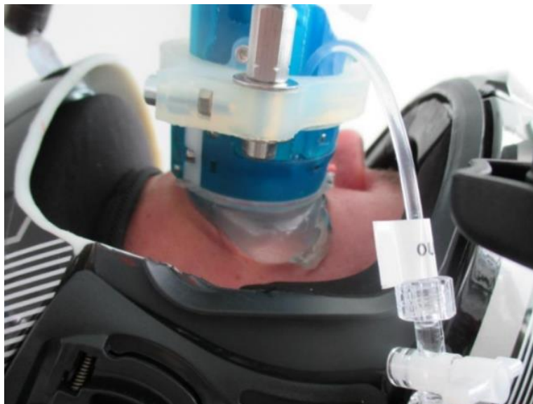
20 pav. Slėgio manžetės, kuri išsipučia į šoną (radialinis išsiplėtimas), esant slėgiui P_e = 35 mmHg, paveikslėlis ir šioje situacijoje nėra galimybės daugiau padidinti slėgio
