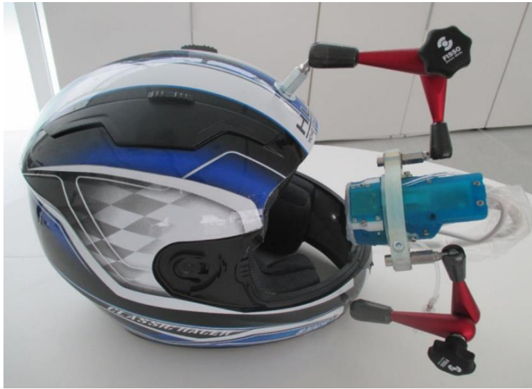
15 pav. Ultragarsinis linijinis keitiklis „L20-5s“ ir išorinio slėgio manžetė, sumontuota laikiklyje, kuris tvirtinamas prie šalmo
