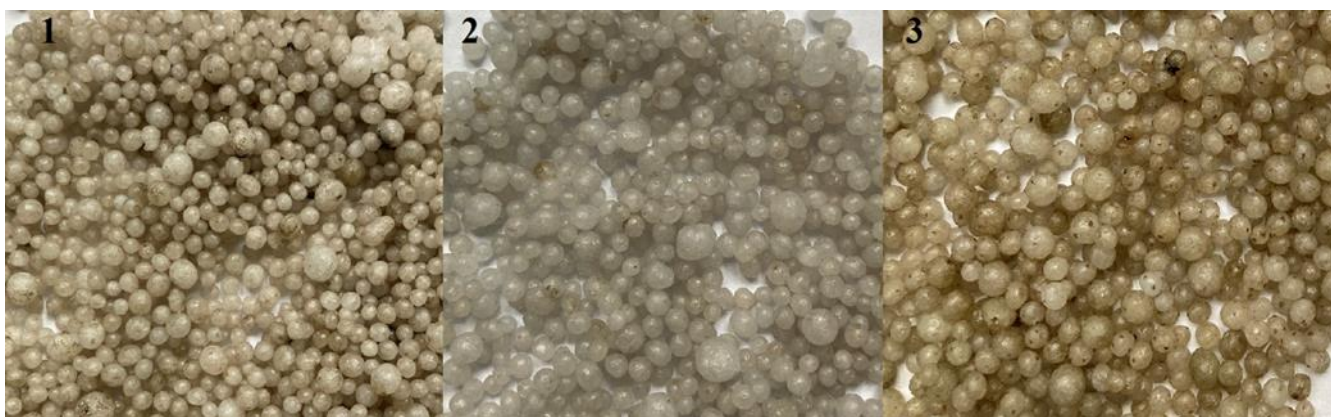
2.7 pav. Be smulkesnės frakcijos dengtos granulės, 1 – gryna danga; 2 – su 10 % papildomo vandens; 3 – su 20 % papildomo vandens
