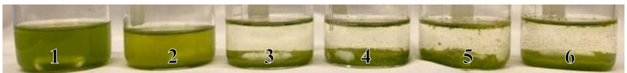
22 pav. Mikrodumbliai ir KK_{0,24}^* flokulės, kai įdėta KK_{0,24}^* dozė atitinkamai yra: 1) 0 mg/g; 2) 0,5 mg/g; 3) 1,1 mg/g; 4) 1,8 mg/g; 5) 2,7 mg/g; 6) 3,6 mg/g
