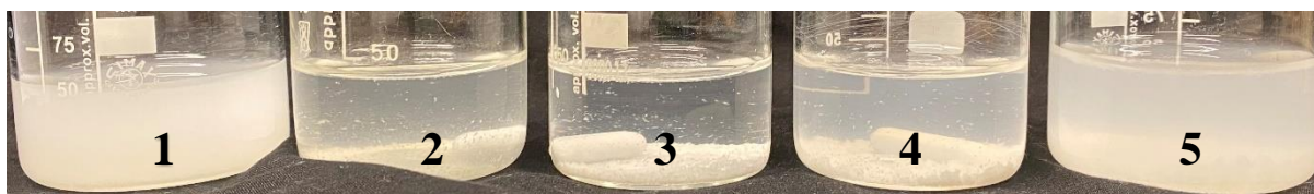
11 pav. Kaolino ir KK_{0,19} flokulės, kai įdėta KK_{0,19} dozė atitinkamai yra: 1) 0 mg/g; 2) 6,8 mg/g; 3) 13,6 mg/g; 4) 27,1 mg/g; 5) 90,4 mg/g
