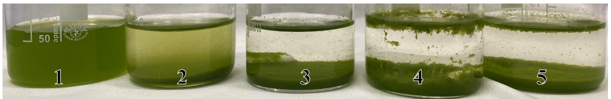
21 pav. Mikrodumblių ir KK_{0,18}^* flokulės, kai įdėta KK_{0,18}^* dozė atitinkamai yra: 1) 0 mg/g; 2) 0,7 mg/g; 3) 1,6 mg/g; 4) 3,6 mg/g; 5) 9 mg/g
