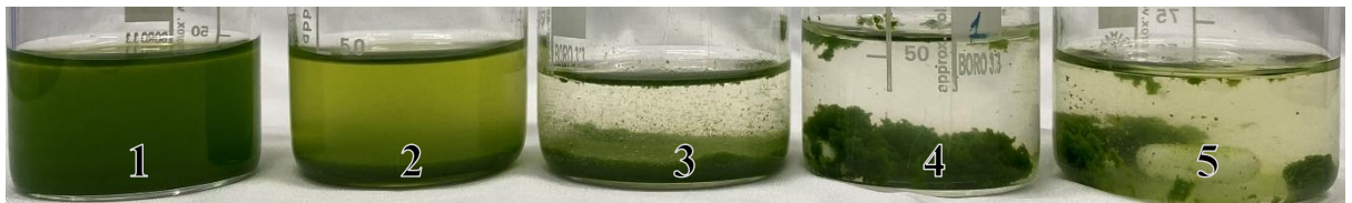
20 pav. Mikrodumblių ir KK_{0,32} flokulės, kai įdėta KK_{0,32} dozė atitinkamai yra: 1) 0 mg/g; 2) 0,6 mg/g; 3) 1,4 mg/g; 4) 5,9 mg/g; 5) 7,8 mg/g
