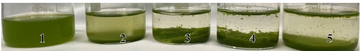
23 pav. Mikrodumblių ir KK_{0,32}^* flokulės, kai įdėta KK_{0,32}^* dozė atitinkamai yra: 1) 0 mg/g; 2) 0,5 mg/g; 3) 1,1 mg/g; 4) 1,6 mg/g; 5) 9,1 mg/g
