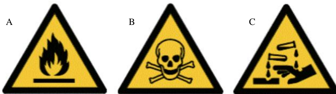
4.1 pav. Įspėjamieji ženklai: A – lengvai užsideganti medžiaga, B – toksiška medžiaga, C – ėsdinančioji medžiaga [78]
