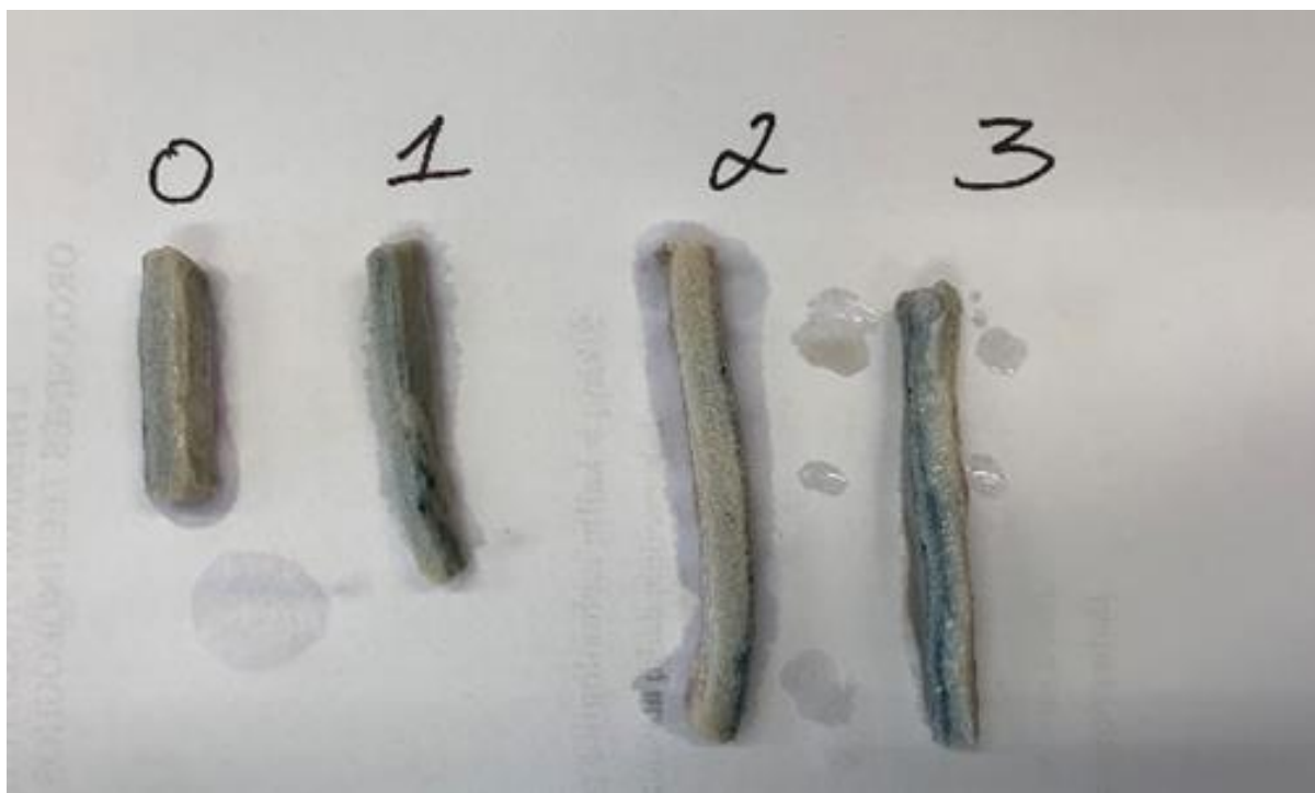
2.7 pav. Bandinių pjūvių nusidažymas indikatoriumi fenolftaleinu, kai neutralizacijai dėta: 0 – (NH 4 ) 2 SO 4 – 4 % (plikinta ir neutralizuota įprastai); 1 – (NH 4 ) 2 SO 4 – 4 %; 2 – (NH 4 ) 2 SO 4 – 2 %; 3 – (NH 4 ) 2 SO 4 – 1 %, CH 3 CH(OH)COOH – 0,8 %
