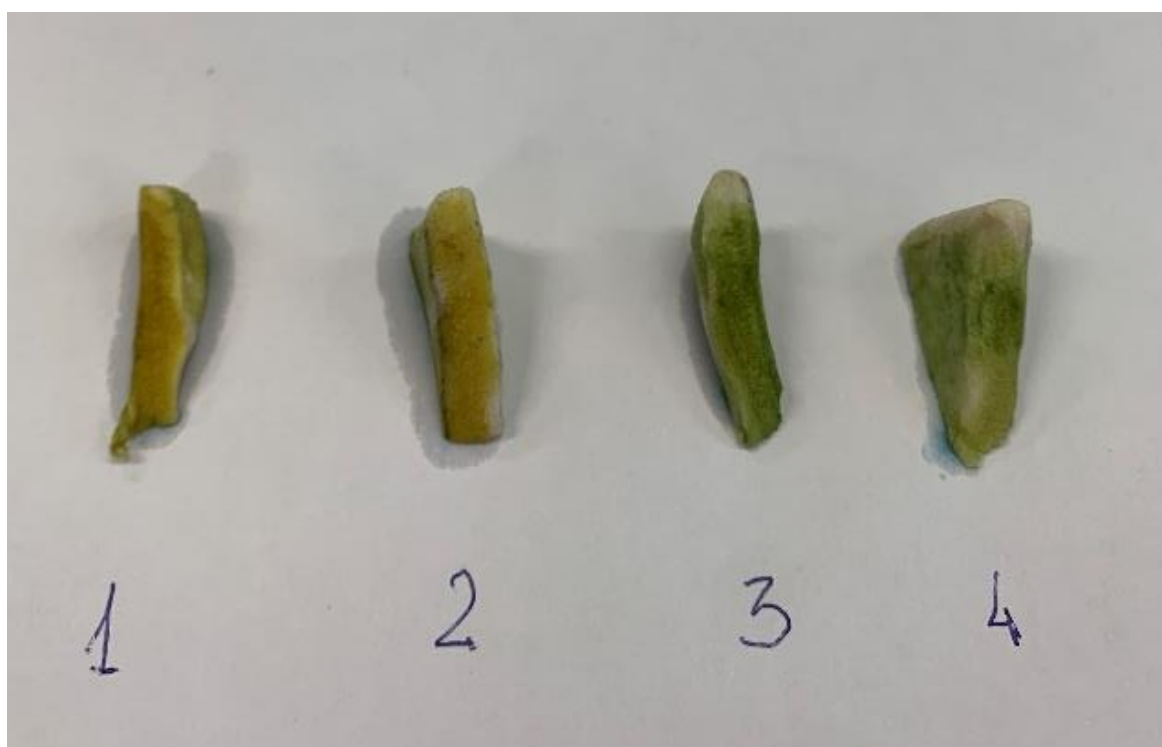
2.9 pav. Odos pjūvių nusidažymas bromkrezolio žaliuoju, kai pikeliavimui dėta: 1 – H 2 SO 4 – 1,5 % (įprastas pikeliavimas), 2 – H 2 SO 4 – 1,5 % (neutralizavimas tinkamiausiu būdu), 3 – H 2 SO 4 – 1 %, 4 – H 2 SO 4 – 1 %; CH 3 COOH – 1 %
