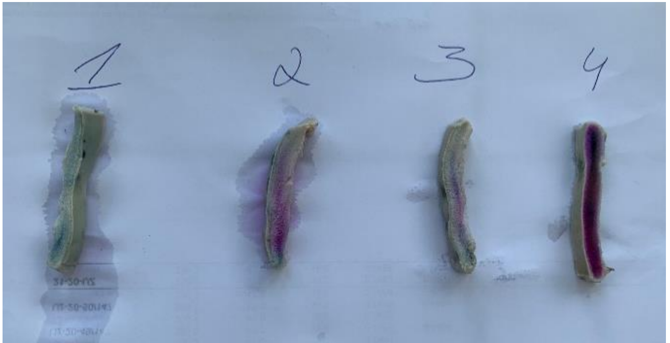
2.5 pav. Odos pjūvių nusidažymas fenolftaleinu, kai neutralizacijai dėta: 1 – (\text{NH}_4)_2\text{SO}_4 – 1 %, \text{CH}_3\text{CH}(\text{OH})\text{COOH} – 0,8 % ; 2 – (\text{NH}_4)_2\text{SO}_4 – 1 %, \text{CH}_3\text{CH}(\text{OH})\text{COOH} – 0,4 % ; 3 – (\text{NH}_4)_2\text{SO}_4 – 1 %, \text{NaCH}_3\text{COO} – 0,2 %, \text{CH}_3\text{COOH} – 0,5 % ; 4 – \text{NaCH}_3\text{COO} – 0,2 %, \text{CH}_3\text{COOH} – 0,5 %, \text{CH}_3\text{CH}(\text{OH})\text{COOH} – 0,4 %
