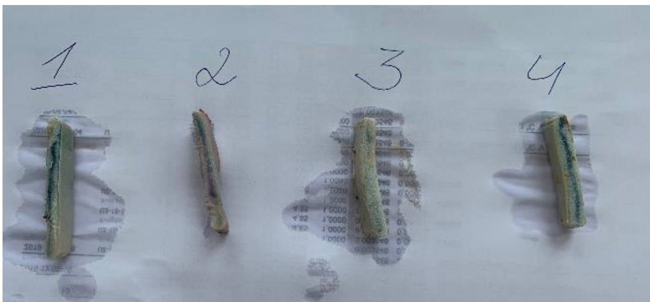
2.4 pav. Odos pjūvių nusidažymas fenolftaleinu kai neutralizacijai dėta: 1 – (\text{NH}_4)_2\text{SO}_4 – 1 %, \text{CH}_3\text{CH}(\text{OH})\text{COOH} – 1,6 % ; 2 – \text{H}_3\text{BO}_3 – 3 % ; 3 – (\text{NH}_4)_2\text{SO}_4 – 1 %, \text{NaCH}_3\text{COO} – 0,3 %, \text{CH}_3\text{COOH} – 2 % ; 4 – \text{NaCH}_3\text{COO} – 0,2 %, \text{CH}_3\text{COOH} – 1,5 %, \text{H}_3\text{BO}_3 – 1,5 %, \text{CH}_3\text{CH}(\text{OH})\text{COOH} – 0,4 %
