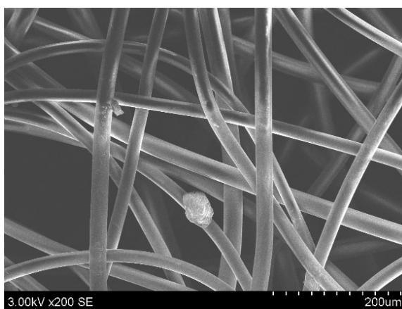
3.1 pav. PLA konstrukto SEM nuotrauka (200x didinimas), polimerinės deformacijos dėl temperatūros
