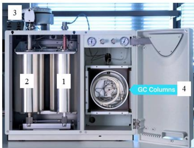
2.3 pav. Flash 2000 pirminės analizės įrenginys: 1 – degimo reaktorių, 2 – redukcijos reaktorių, 3 – automatinė bandinių paėmimo sistema, 4 – dujų chromatografijos kolonėlė.
