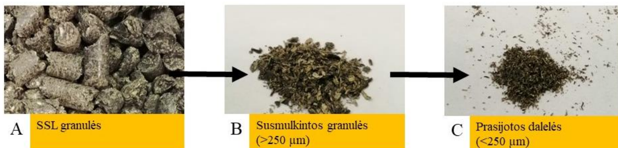
2.4 pav. SSL granulių paruošimas termogravimetrinei analizei
