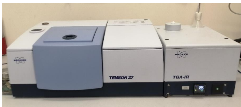
2.8 pav. Bruker Tensor 27 TGA-IR spektroskopijos įrenginys
