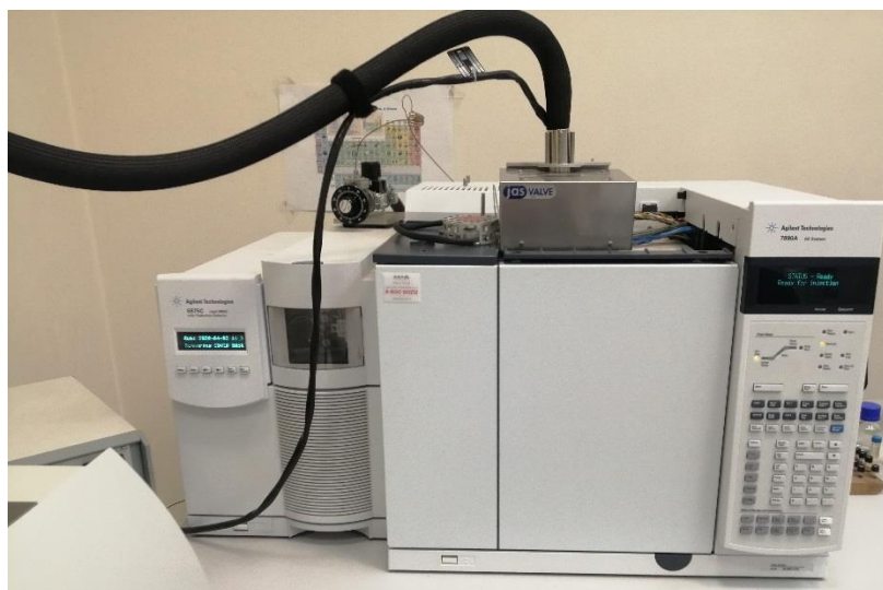
2.9 pav. Agilent 7890A dujų chromatografas su kvadrupoliniu masių spektrometrijos detektoriumi Agilent 5975C
