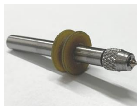
Рисунок 5 – Спеціальна цанга із закріпленим штоком клапана
