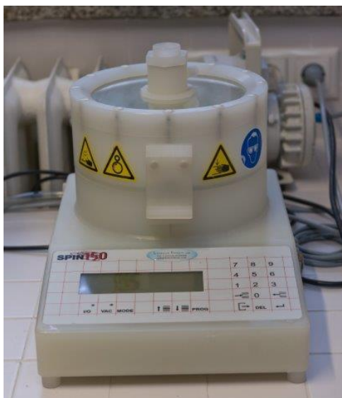
2.2 pav. SPIN 150-v3-NPP plėvelių liejimo įrenginys
