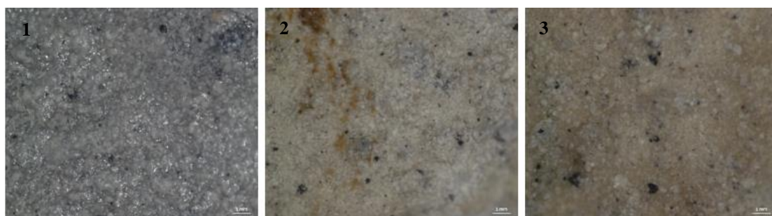
20 pav. XII receptūros plėvelių, laistytų vandeniu, vaizdas pro mikroskopą: 1) prieš bandymą; 2) po 14 dienų žemėje; 3) po 21 dienos žemėje
