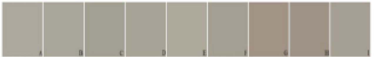
1.5 pav. Odos ęsdintos su \text{FeSO}_4 ir daųytos paprastojo kaųtono ekstraktu (tik vandeninė ekstrakcija; A: 1 %, B: 3 % ir C: 5 % \text{FeSO}_4 ęsdiklio; 0,1 % NaOH ekstrakcija; D: 1 %, E: 3 %; F: 5 % \text{FeSO}_4 ęsdiklio; 0,5 % NaOH ekstrakcija; G: 1 %; H: 3 %; I: 5 % \text{FeSO}_4 ęsdiklio, pavirųšinę pusę) [49]
