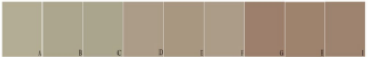
1.4 pav. Odos ęsdintos su \text{Al}_2(\text{SO}_4)_3 ir daųytos paprastojo kaųtono ekstraktu (tik vandeninė ekstrakcija; A: 1 %, B: 3 % ir C: 5 % \text{Al}_2(\text{SO}_4)_3 ęsdiklio; 0,1 % NaOH ekstrakcija; D: 1 %, E: 3 %; F: 5 % \text{Al}_2(\text{SO}_4)_3 ęsdiklio; 0,5 % NaOH ekstrakcija; G: 1 %; H: 3 %; I: 5 % \text{Al}_2(\text{SO}_4)_3 ęsdiklio, išvirųšinę pusę) [49]
