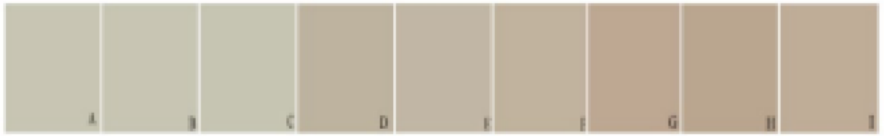
1.3 pav. Odos ęsdintos su \text{Al}_2(\text{SO}_4)_3 ir daųytos paprastojo kaųtono ekstraktu (tik vandeninė ekstrakcija; A: 1 %, B: 3 % ir C: 5 % \text{Al}_2(\text{SO}_4)_3 ęsdiklio; 0,1 % NaOH ekstrakcija; D: 1 %, E: 3 %; F: 5 % \text{Al}_2(\text{SO}_4)_3 ęsdiklio; 0,5 % NaOH ekstrakcija; G: 1 %; H: 3 %; I: 5 % \text{Al}_2(\text{SO}_4)_3 ęsdiklio, pavirųšinę pusę) [49]
