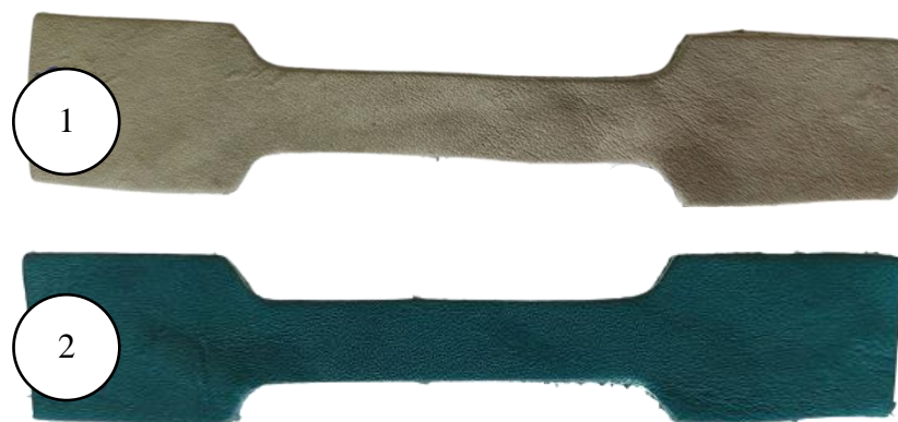
2.2 pav. Dažyti ir įriebinti bandiniai (1– eksperimentinis, 2 – kontrolinis)
