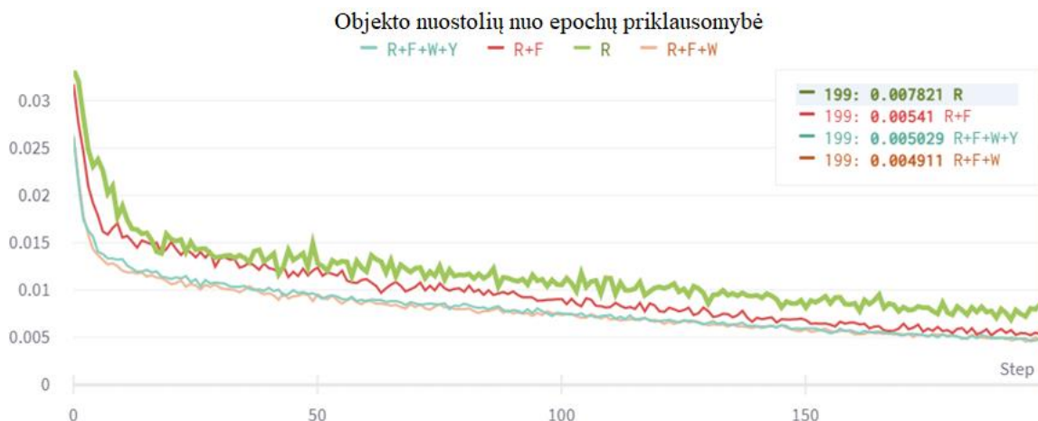
38 pav. YOLOv5l tinklo regiono ir objekto nuostoliai
