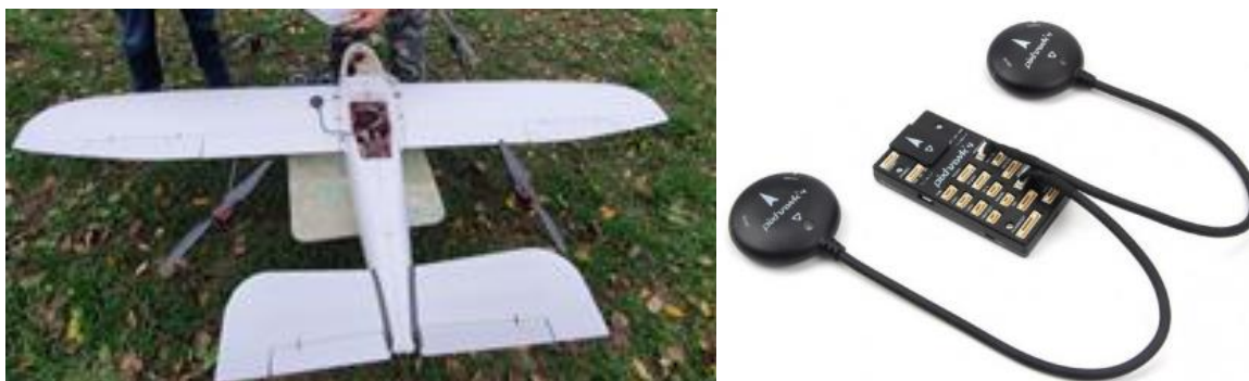
19 pav. a) Flying dragon 2160 modelis b) Pixhawk 4 su dviem GPS moduliais
