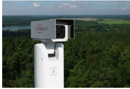
4 pav. Bokštas su įmontuota kamera skirta miško būklės stebėsenai
