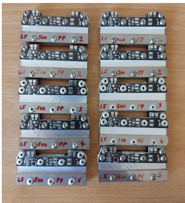
3.4 pav. Pjezoelektriniai elektros energijos generatoriai su 500 \mu\text{m} ir 800 \mu\text{m} polipropileninėmis (PP) šerdimis
