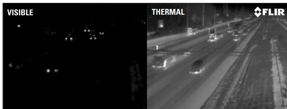
1.4 pav. Kameros ir termovizoriaus veikimas [6]
