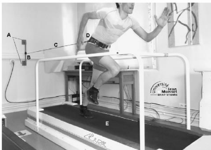
4 pav. Modifikuotas bėgtakis, skirtas atletų jėgos ir greičio matavimams
