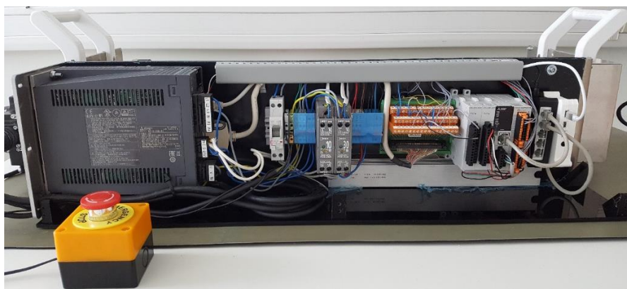
19 pav. Sistemos elektrinių komponentų sujungimo vaizdas
