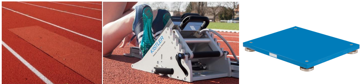
10 pav. Jėgos plokštės. Iš kairės: integravimas manieže, integravimas į starto bloką bei pati plokštė
