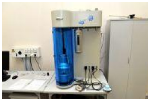
12 pav. „Quantachrome AUTOSORB-iQ-K/MP“ kietųjų kūnų porų dydžio bei savitojo paviršiaus ploto analizatorius.
