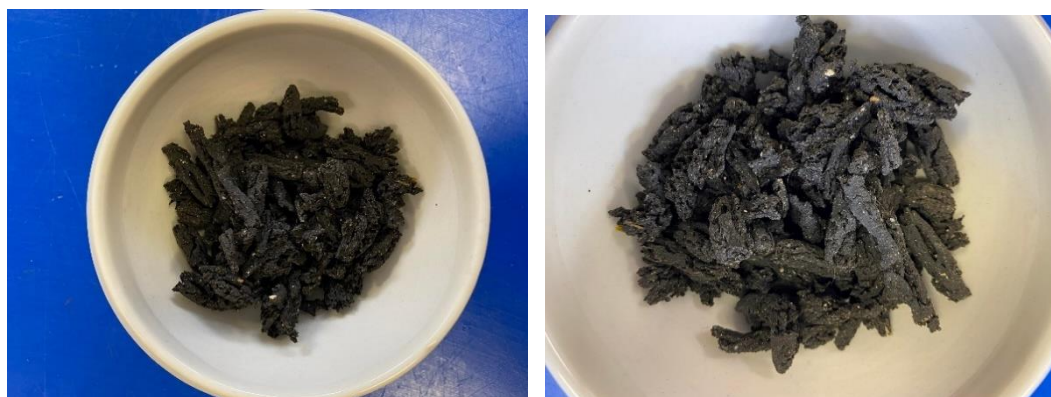
18 pav. Džiovinto nuotekų dumblo granulės, kurios buvo naudotos gaminant vieną iš adsorbentų
