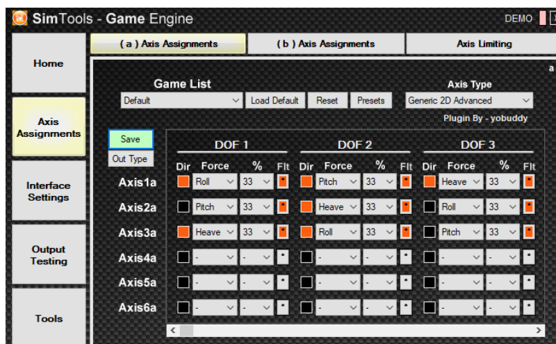
25 pav. Prototipo ašių konfigūracijos langas SimTools programoje
