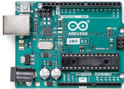
21 pav. Arduino UNO R3 mikrovaldiklis [14]
