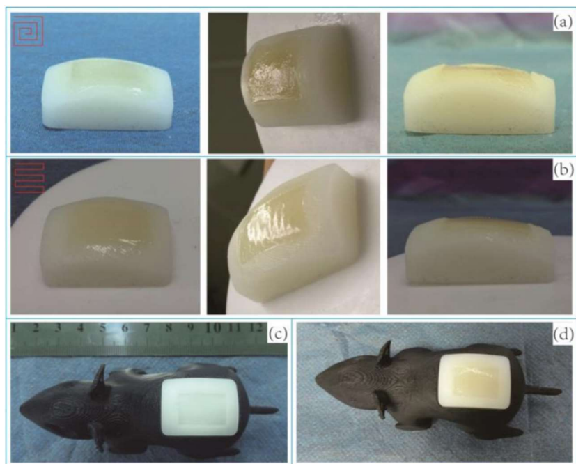
22 pav. a) defekto užpildymas rato trajektorija; b) defekto užpildymas lygiagrečia trajektorija; c) pelės modelis be užpildyto defekto; d) pelės modelis su užpildytu defektu [31].
