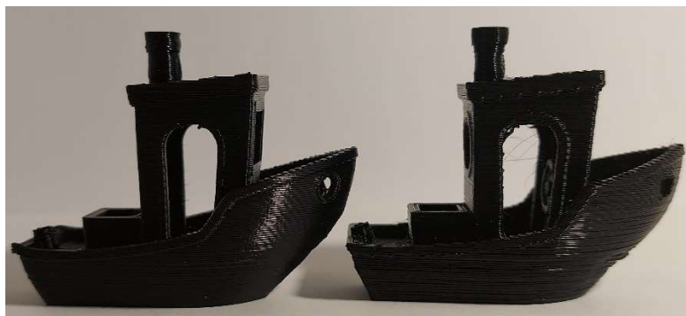
45 pav. Atspausdinti „3D benchy“ bandiniai Prusa MK3S (kairėje) ir realizuota sistema (dešinėje)
