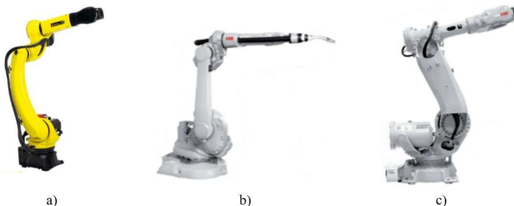
9 pav. Pramoniniai robotai: a) Fanuc M-20iD-25 [13]; b) ABB IRB1600ID-4/1.5 [14]; ABB IRB 6640-185/2.8 [15].
