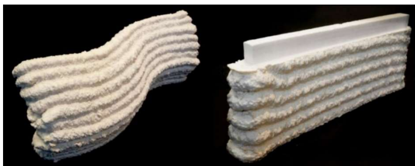
18 pav. Daugiafunkcinės gamybos sistemos bandinys iš polorono prieš mechaninį apdirbimą (kairėje) ir po [28].
