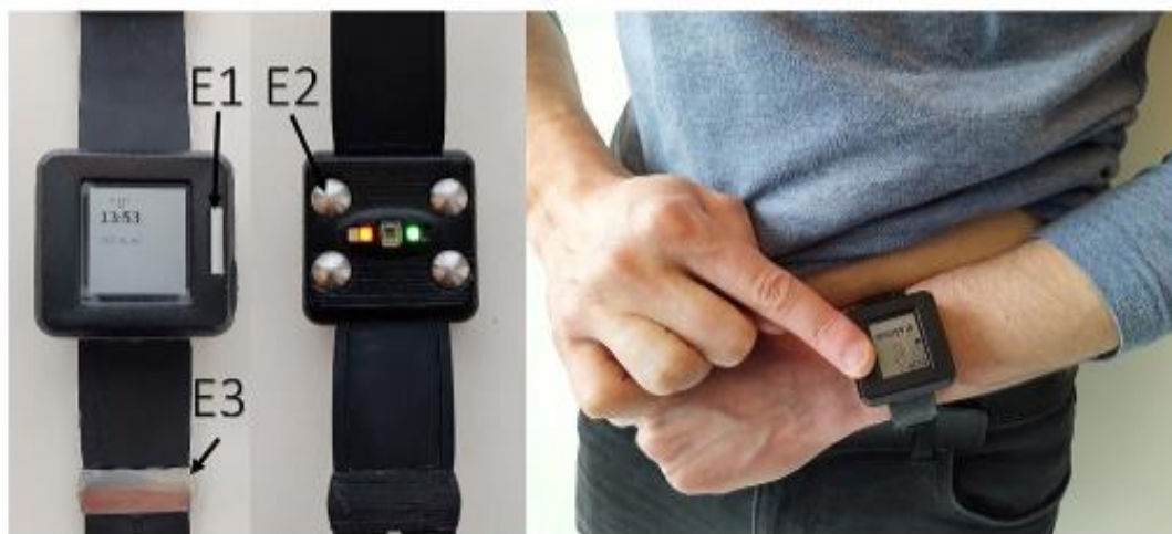
16 pav. Ant rankos dėvimo prietaiso su trimis elektrodais prototipas bei 6 derivacijų EKG signalo registravimo demonstracija [62]
