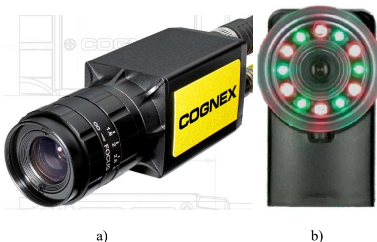
11 pav. Kamerų tipai: a) skaitmeninė; b) savarankiška vaizdo sistema [30–31]
