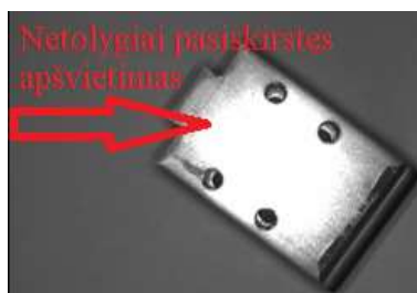
19 pav. „Sick“ PIM60 kameros šviesos šaltiniu apšviesta tiriamą detalę
