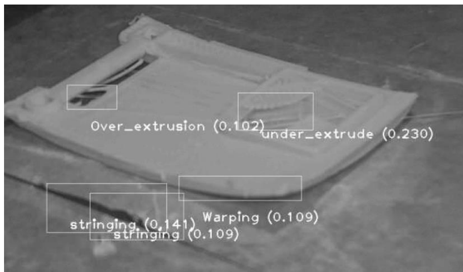
53 pav. Nustatytas deformacijos brokas
