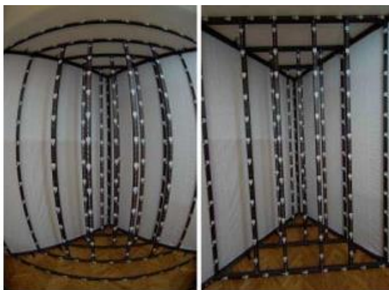
19 pav. „Žuvies akies“ efektas [22]: a) prieš kalibravimą; b) po kalibravimo
