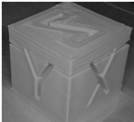
9 pav. Sluoksnių atsiskyrimas
