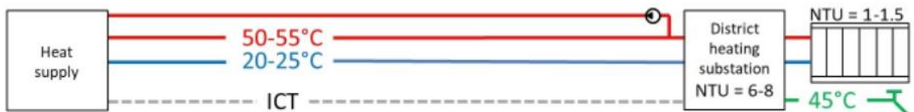
6.5 pav. Trijų vamzdžių šilumnešio tiekimo sistema [27]
