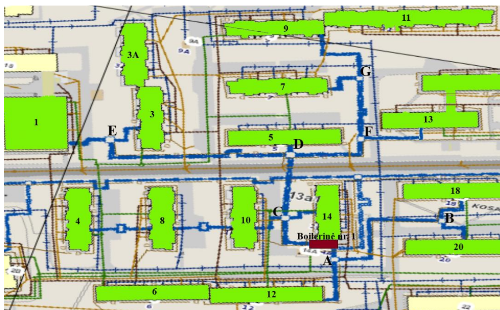
5.1 pav. Kosmonautų rajono pastatų, prijungtų prie boilerinės Nr. 1 schema
