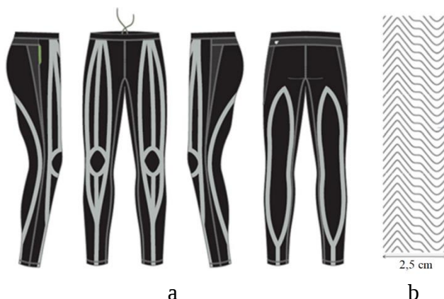
1.13 pav. Sportinės tamprės su klijuotinėmis silikoningėmis juostomis: a – tamprių dizainas; b – silikoningės juostos struktūra [27]
