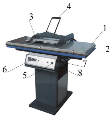
2.1 pav. Klijavimo preso STIROVAP MP 98 schema: 1 – viršutinė preso plokštuma; 2 – apatinė preso plokštuma; 3 – viršutinės preso plokštumos prispaudimo ir fiksavimo rankena klijavimo proceso metu; 4 – viršutinės preso plokštumos pakėlimo rankena; 5 – įjungimo ir išjungimo mygtukas; 6 – temperatūros ir laiko rodmenų ekranas; 7 – viršutinės preso plokštumos pakėlimo rankena po klijavimo proceso; 8 – plokštumų prispaudimo reguliatorius
