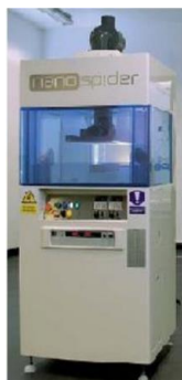
16 pav. Elektrinio verpimo įrenginys „NanoSpider™“ („Elmarco“, Čekija) [61]
