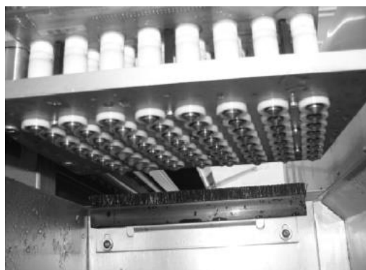
8 pav. Spausdintuvo galvutės su 64 angom vaizdas [14]
