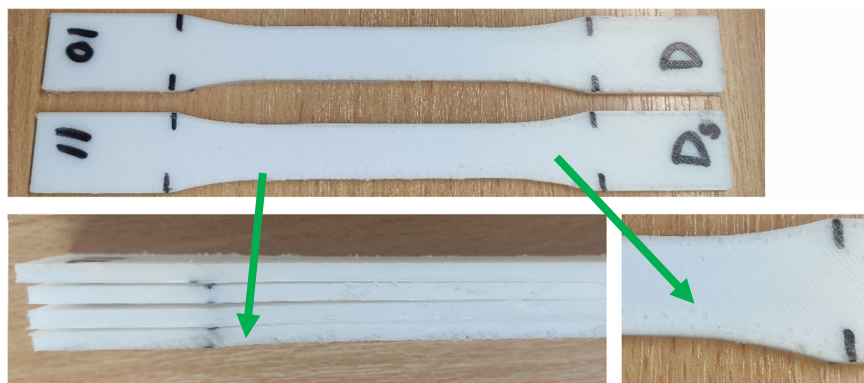
2.4 pav. „Diamond“ užpildo bandinių paviršiaus defektai
