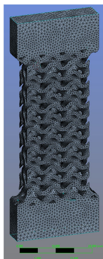
3.14 pav. „Gyroid“ bandinio baigtinių elementų tinkelis
