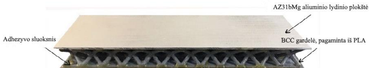
1.10 pav. Sluoksniuota plokštė su BCC topologijos šerdimi, pagaminta iš PLA [25]
