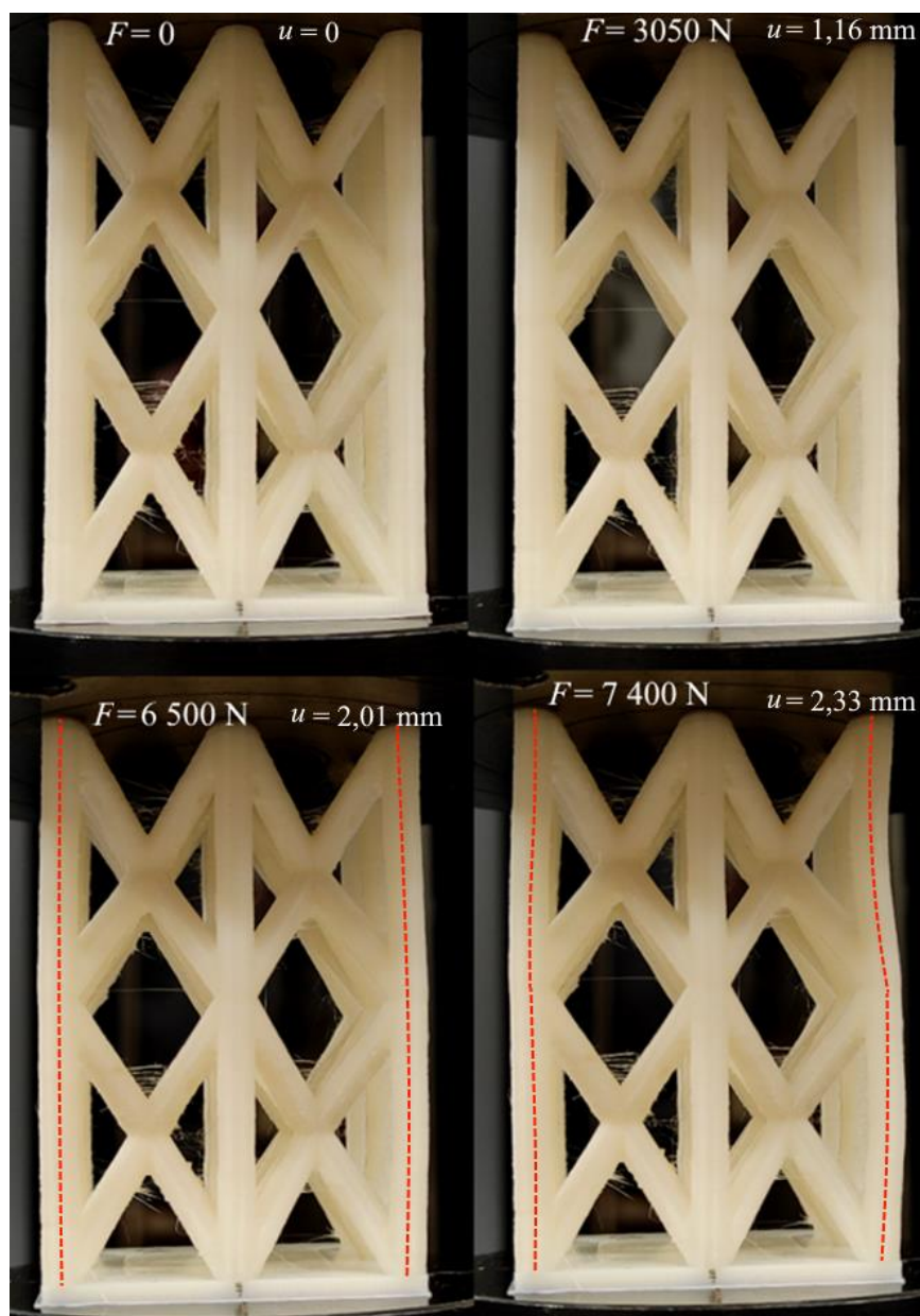
4.2 pav. 3-io BCCZ gardelinės struktūros bandinio deformacijos eiga bandymo metu
