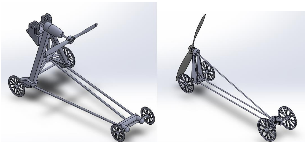
24 pav. Natūrinių „DDFTTW“ modelių izometriniai vaizdai, kairėje – pirmas natūrinis modelis, be mechaninės perdavos, dešinėje – antras natūrinis modelis (pilnai surinktas)
