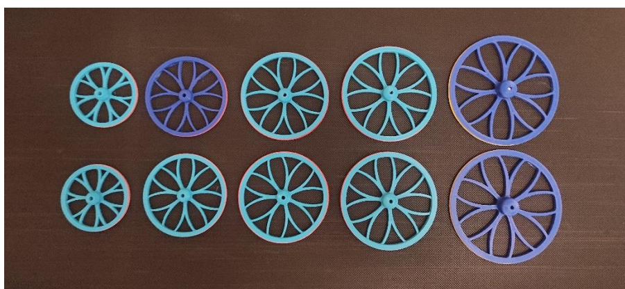
43 pav. Eksperimentinio tyrimo metu naudotos ratų poros (rato spinduliai - 40, 50, 55, 60, 70 mm.)
