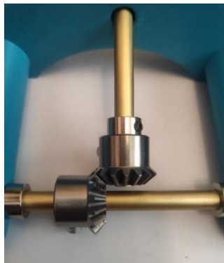
22 pav. Kūginių dantračių pora naudota eksperimentiniame modelyje
