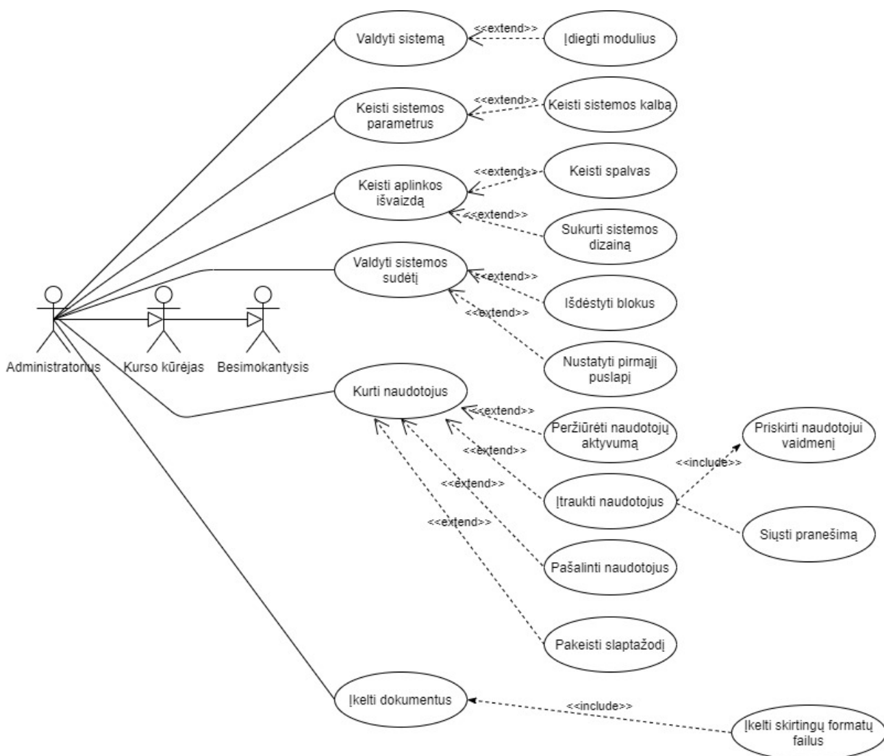
14 pav. Paramos sistemos administravimo posistemio PA diagrama
