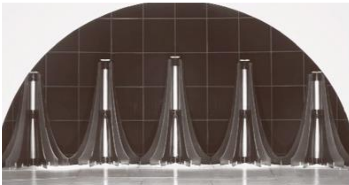
18 pav. Turbulentiško srauto sukūrimas oro tunelyje [21]
