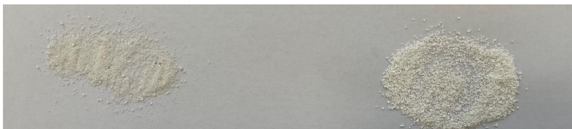
18 pav. Katalizatoriaus matricos dalelės. Kairėje: 50 – 200 mikronų, dešinėje : 600 – 1200 mikronų
