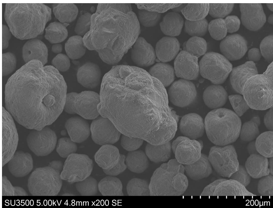
24 pav. Katalizatoriaus matricos dalelės 500 – 200 mikronų SEM mikroskopu, x200 didinimas
