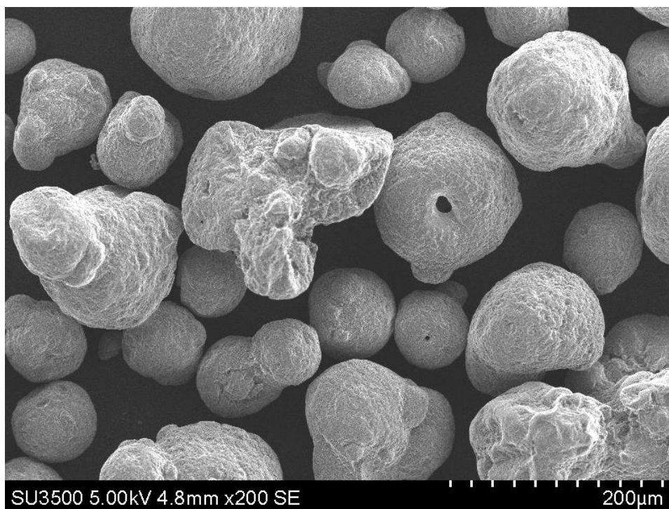
36 pav. Katalizatoriaus dalelės 50 – 200 mikronų SEM mikroskopu. x200 didinimas. Po užpildymo
