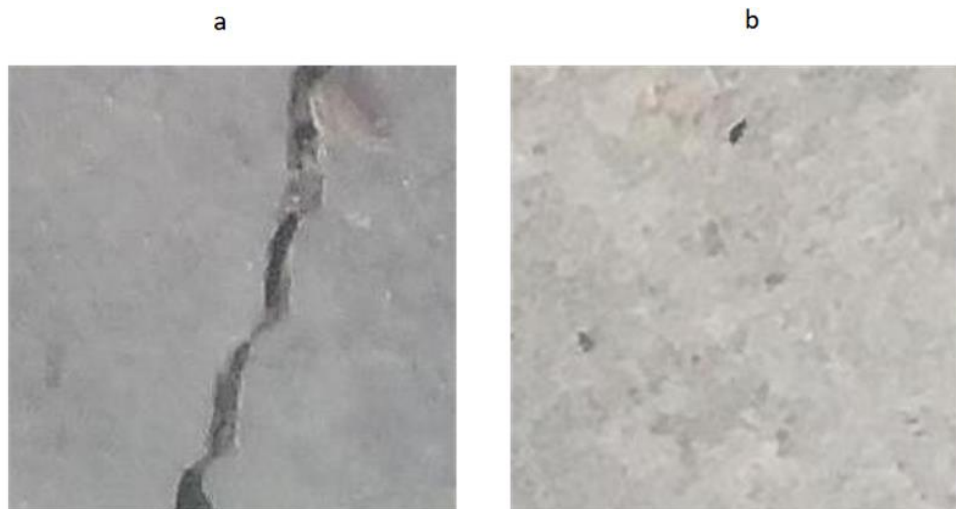
5 pav. Įtrūkusio a ir sveiko b betono pavyzdys iš apmokymo imties
